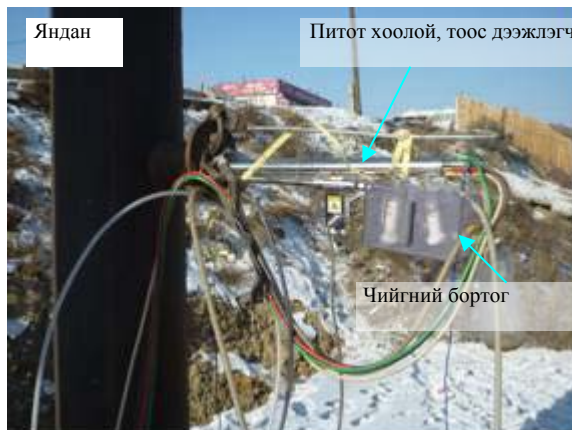
Зураг 2.2-4 Утааны хийн хэмжилт (2 дахь жилийн өвөл: Автомат ажиллагаатай тоосны дээж авагч)
